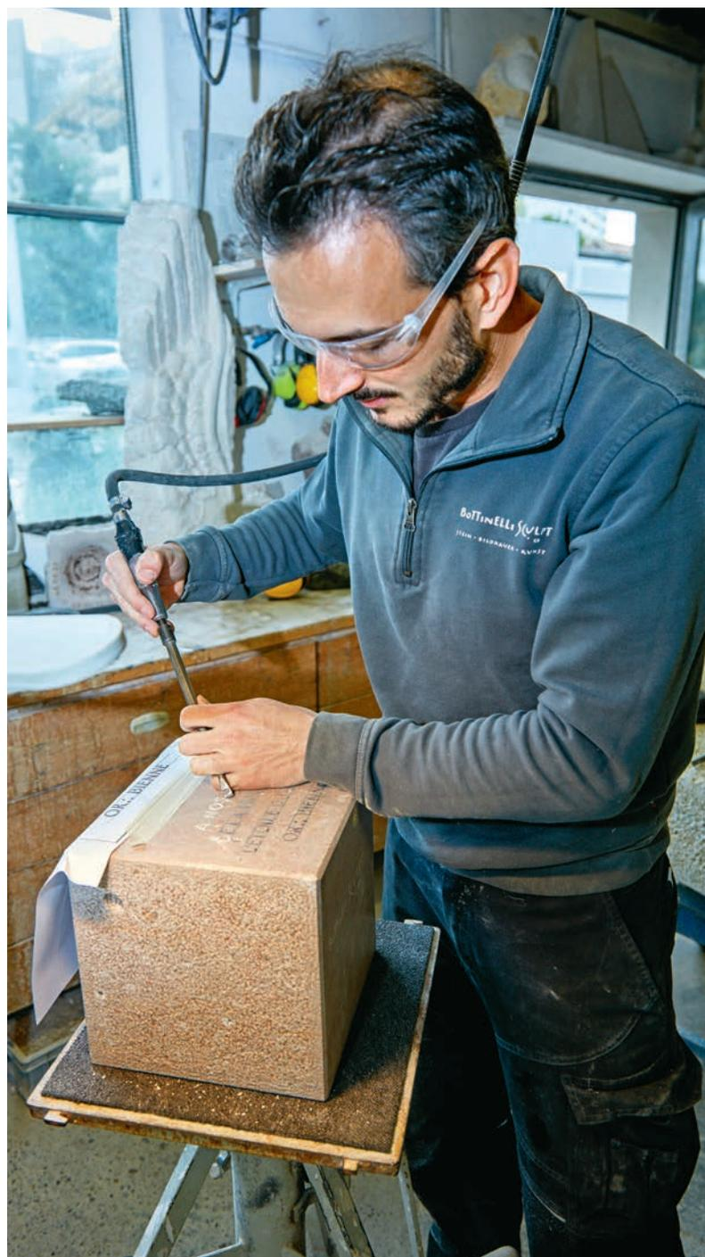
On peut aussi façonner la pierre avec de l'air comprimé.
