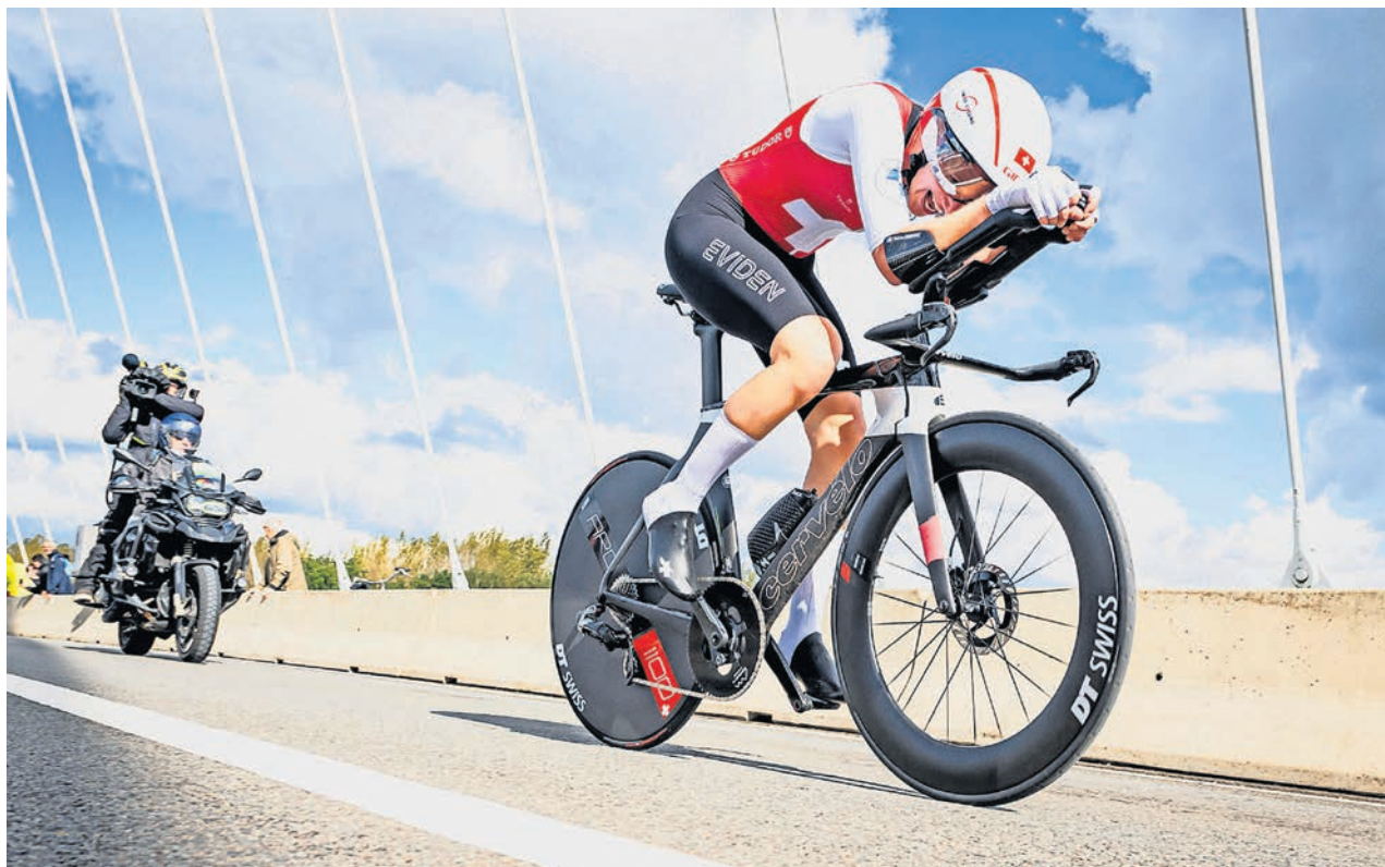
Elena Hartmann an der EM in Limburg 2024. Das Zeitfahr-Rennrad zeichnet sich unter anderem durch einen speziellen Lenker mit Liegeaufsatz und durch ein Scheibenrad aus.
