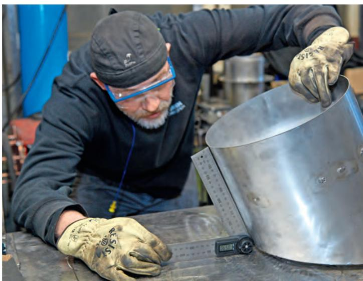
Les processus nécessaires à la fabrication d'un poêle à bois ne se basent pas sur une technologie de pointe, mais en ce qui concerne les exécutions sur mesure, un travail millimétré est indispensable.
